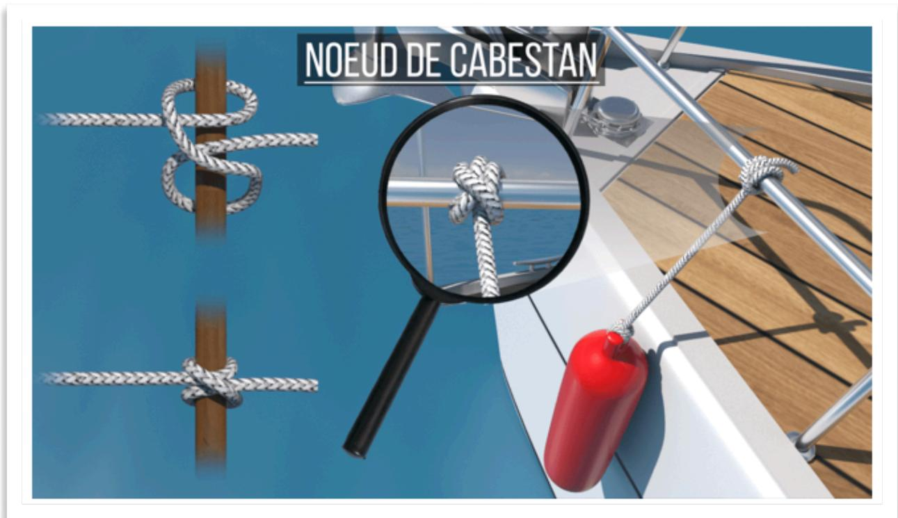
Rapide à faire et à défaire, il ne risque pas de s'ouvrir sous la tension, sans pour autant se souquer (c'est-à-dire sans se serrer de lui-même sous l'effet des tensions, jusqu'à devenir très difficile à dénouer). Les deux brins se serrent indépendamment sous la traction, mais si la tension se relâche, ce nœud peut se desserrer. Il est possible de le nouer au milieu d'un cordage, même si les deux extrémités ne sont pas accessibles.
