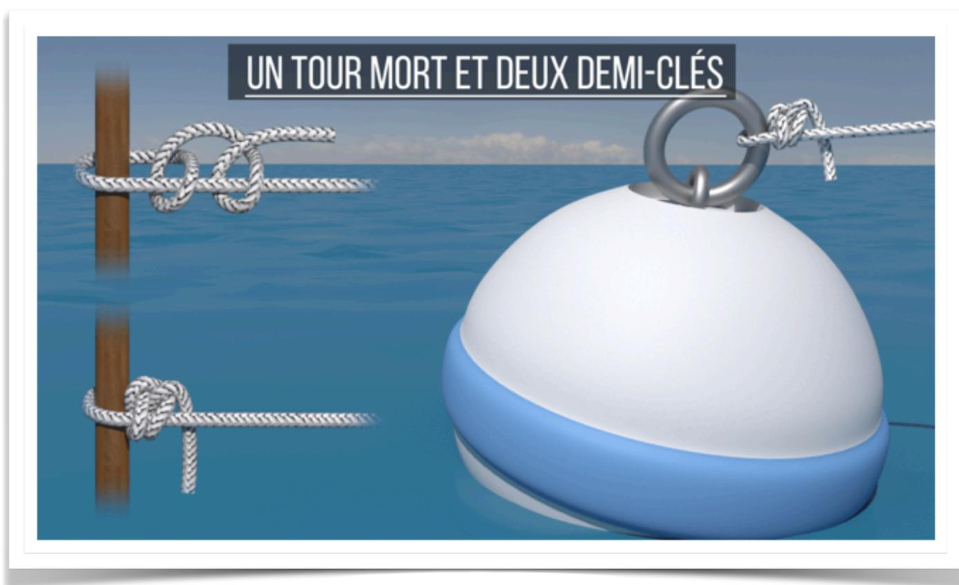
C'est le premier noeud à connaître lorsque l'on devient équipier. C'est un noeud simple, il s'exécute rapidement. Il peut même être utilisé lorsque le cordage est sous tension.
